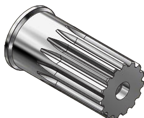
SHAFT W DIN 5482 B25 x 22h9 14zx1.6mx30Px9h
